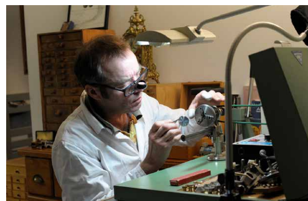
Un maître horloger fabriquant une pièce sur son tour horloger pour un objet à restaurer (atelier Bruno Laville).
